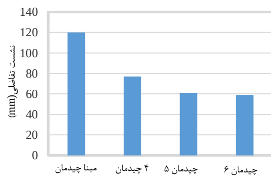
شکل ۱۴: نشست تفاضلی به ازای چیدمان‌های مختلف، حالت بارگذاری ۲
