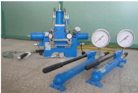
شکل ۵: دستگاه آزمایش برش مستقیم
