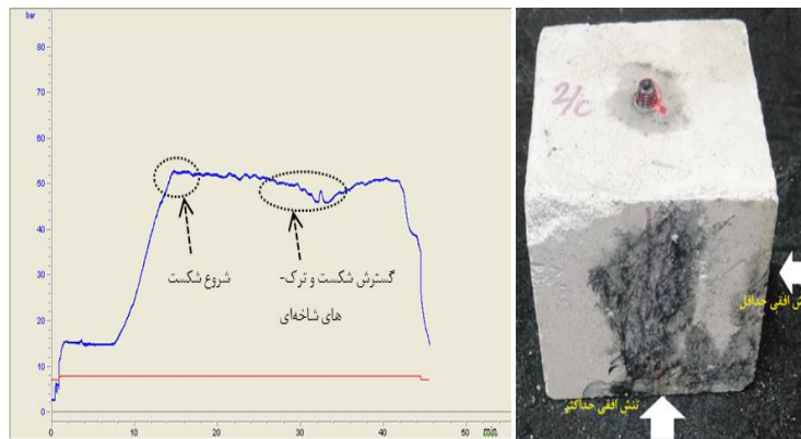
شکل ۱۰: بررسی تأثیر شکل مشبک بر هندسه شکست: (الف) نمونه شکسته شده با مشبک مخروطی، (ب) نمودار فشار- زمان (آزمایش شماره ۲)
