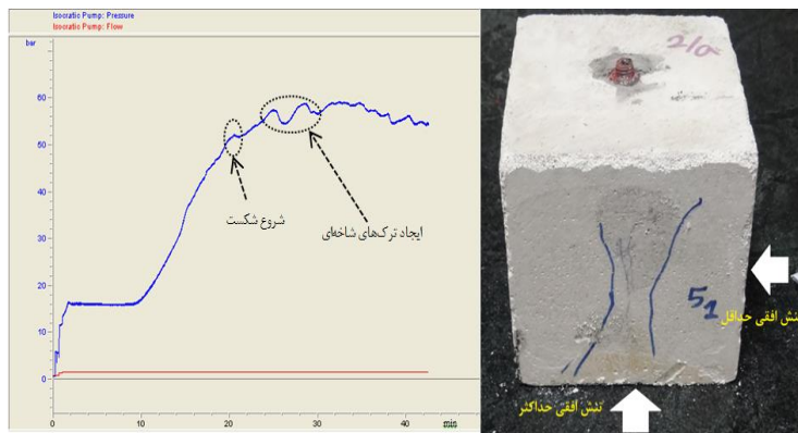
شکل ۱۱: بررسی تأثیر شکل مشبک بر هندسه شکست: (الف) نمونه شکسته شده با مشبک استوانه‌ای، (ب) نمودار فشار- زمان (آزمایش شماره ۴)
