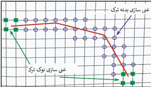
شکل ۱: غنی‌سازی بدنه و نوک ترک در روش اجزا محدود توسعه یافته (تغییر یافته از [۳۰])
