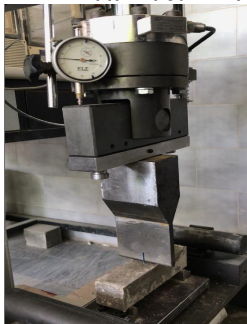
شکل ۱: نمونه ملات سیمانی تحت بارگذاری خمشی
