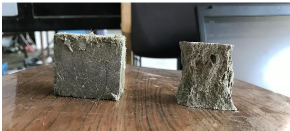
شکل ۸: نمونه شاهد (سمت راست) و نمونه حاوی پلی پروپیلن (سمت چپ) پس از شکست در آزمون فشاری
