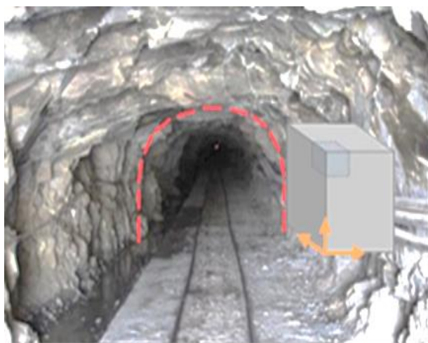
شکل ۲- نحوه تهیه و آماده‌سازی نمونه‌ها از بلوک‌های تهیه‌شده [۹]
