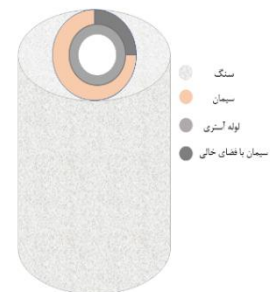
شکل ۷: گستره فضای خالی بین سیمان و لوله آستری (۲۵ درصد فضای کلی).
