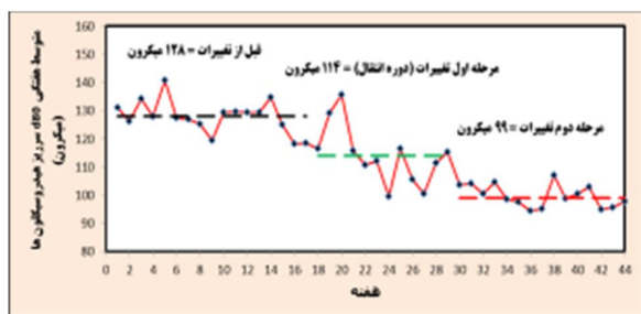
شکل ۶: تغییرات d_{80} سرریز هیدروسیکلون در مراحل مختلف اعمال تغییرات (داده‌های واحد متالورژی کارخانه در سال ۱۳۹۰)
