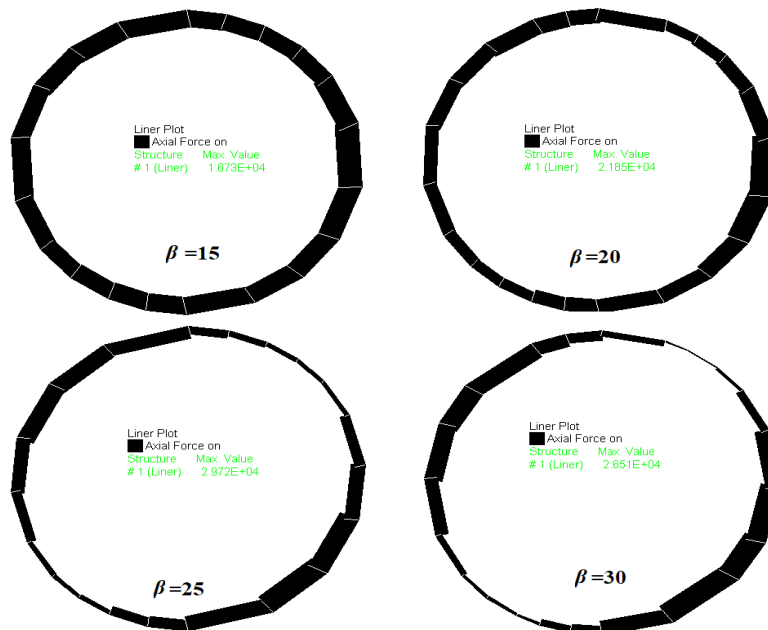
شکل ۱۵: کانتور نیروی محوری (N) القایی در سطح مقطع لوله ناشی از تغییر شکل‌های بیضوی ایجادشده به وسیله‌ی بار زمین‌لرزه.
