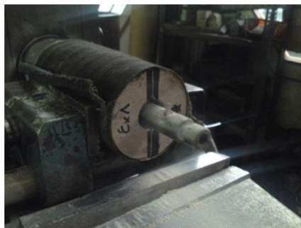
شکل 4: ایجاد ترک‌های مصنوعی بر نمونه
