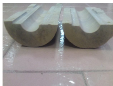
شکل 11: نمونه شکسته شده به‌صورت باز شده خارج از سلول
