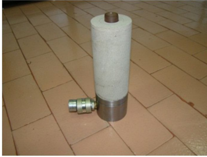
شکل 8: غشا انعطاف‌پذیر در داخل نمونه و متصل به صفحه بارگذاری
