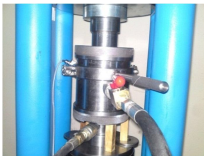
شکل 9: سلول سه محوری بعد از متصل کردن پمپ‌ها به ورودی‌های سلول
