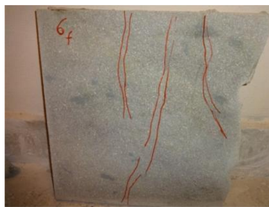
شکل ۵: مشخص کردن سطوح ضعف روی سطح نمونه قبل از شکست
