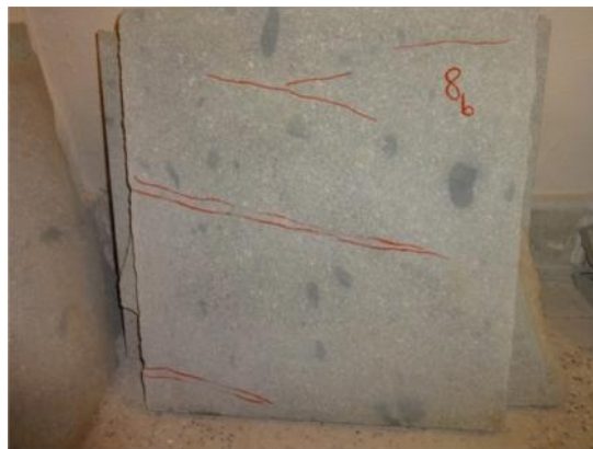
شکل ۱: نمونه‌ای از علامت‌گذاری سطوح ضعف با رنگ قبل از آزمایش شکست
