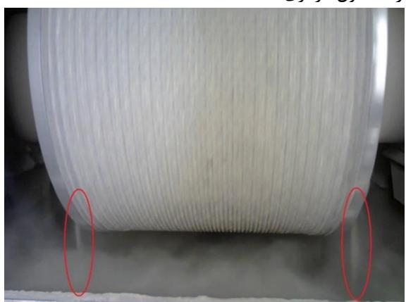
شکل ۴: میانبر زدن خوراک در لبه‌های غلتک‌های *HPGR*
