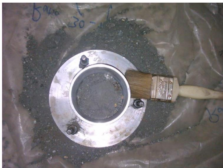
شکل ۱۴: تفکیک محصول مرکزی و محصول لبه با استفاده از پانچ ۸۰ میلی‌متری
