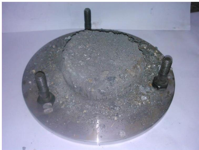
شکل ۱۶: کیک حاصل از آزمایش سیلندر و پیستون در نیروی  $1100\text{ kN}$
