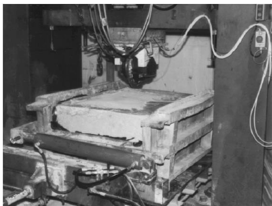
شکل ۷: آزمون آزمایشگاهی برش سنگ [۲۱]
