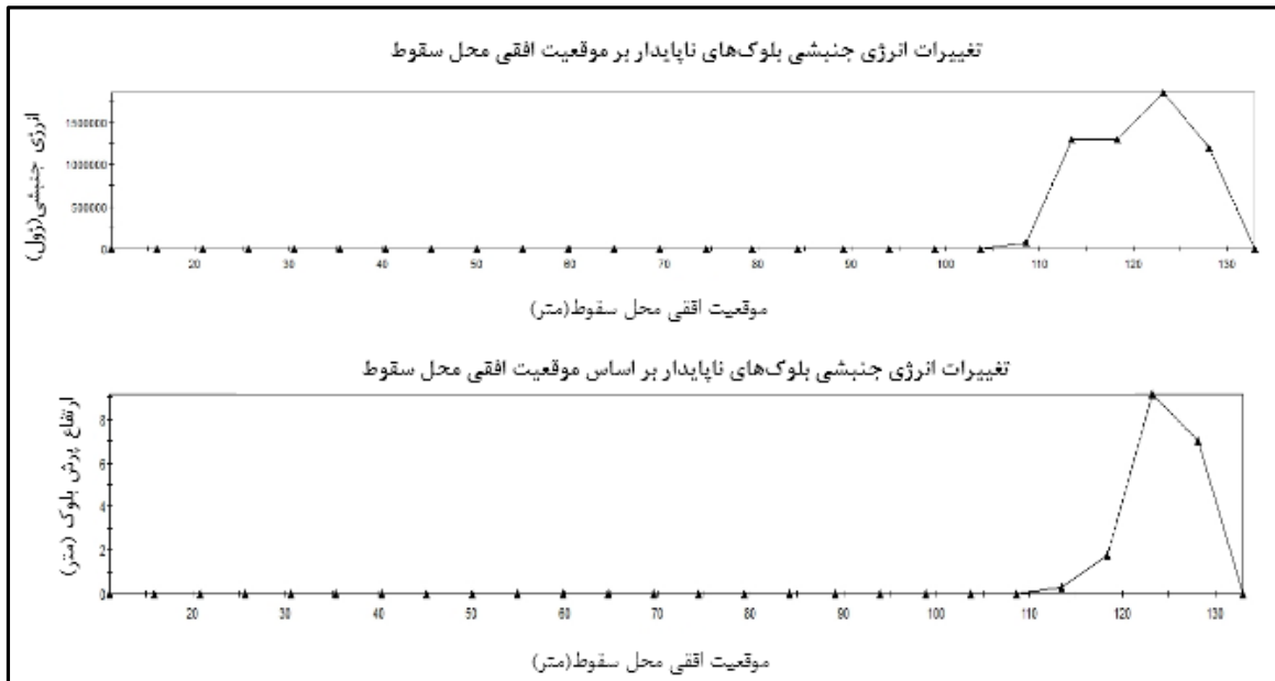
شکل ۱۰: شبیه‌سازی مقادیر انرژی جنبشی و ارتفاع پرش بلوک‌های ناپایدار زون ۱۳ بر اساس موقعیت افقی محل سقوط
