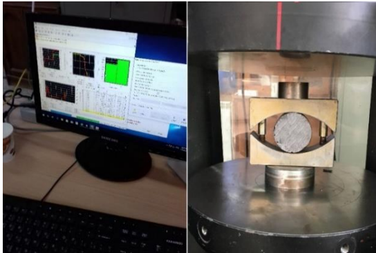
شکل ۲: سیستم بارگذاری و سیستم ثبت داده‌های انتشار آکوستیک
