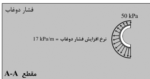
شکل ۵: فشار تزریق دوغاب پشت خط لوله.
