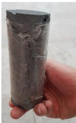
شکل ۷: نمایش صفحات شکست در یک نمونه تحت آزمایش مقاومت فشاری تک‌محوره.
