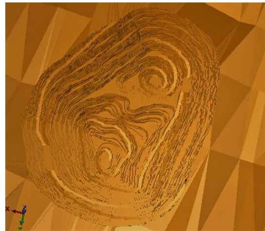
شکل ۳: مدل سه‌بعدی پیت عملیاتی محدوده نهایی معدن مس عینک.
