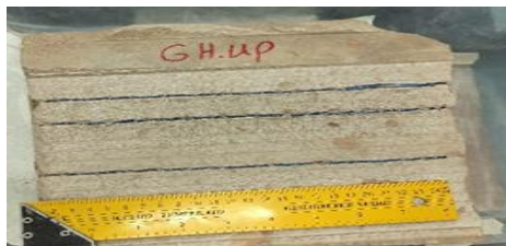
شکل ۵: نمونه های برش خورده در آزمایش برش خطی کوچک مقیاس با عمق برش ۲ میلی متر
