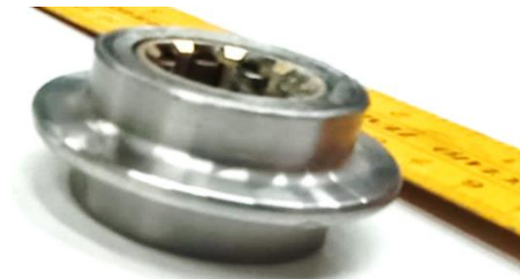
شکل ۴: ابزار برش دیسکی با مقطع ثابت مورد استفاده در آزمایش برش خطی کوچک مقیاس
