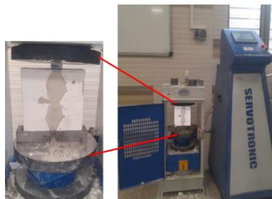
شکل ۳: آزمایش برش پانچ روی فصل مشترک سنگ- بتن
