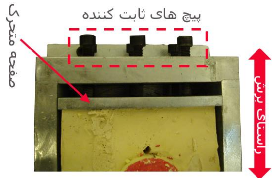
شکل ۶: طراحی جعبه برش همراه با یک صفحه متحرک عمود بر راستای برش و پیچ‌های ثابت‌کننده
