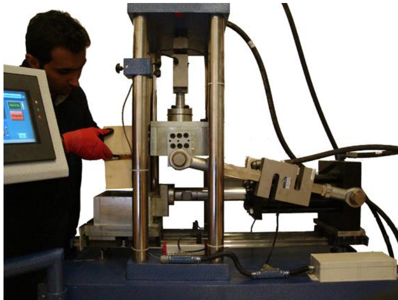
شکل ۸: موقعیت بازوهای دستگاه در هنگام قرار دادن نمونه‌های بالا و پایین به صورت یک تکه در جعبه برش
