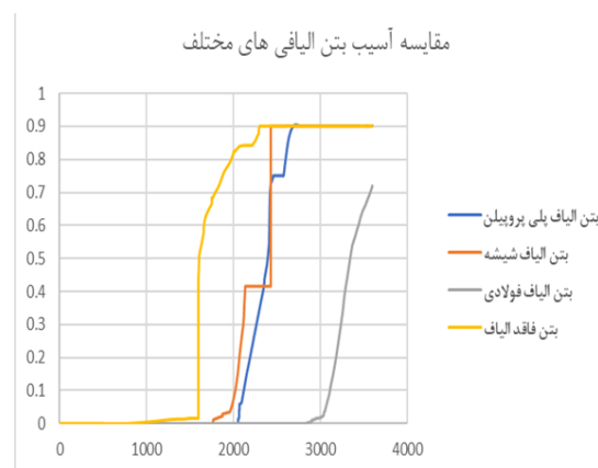
شکل ۱۱: نتایج حاصل از تحلیل آسیب در بتن‌های مختلف در نقطه مذکور، حین آتش‌سوزی.
