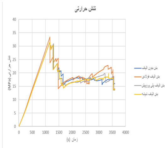
شکل ۹: نتایج حاصل از تحلیل تنش حرارتی در بتن های مختلف در نقطه مذکور، حین آتش سوزی.
