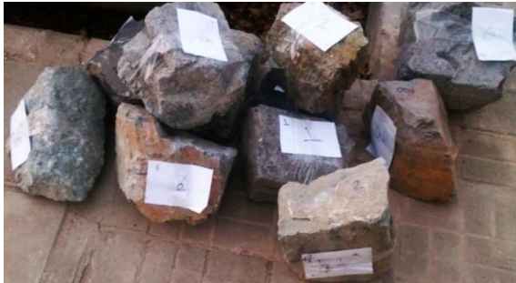
شکل ۴: برخی از نمونه‌های اخذ شده از بلوک‌های انفجاری جهت انجام تست‌های آزمایشگاهی
