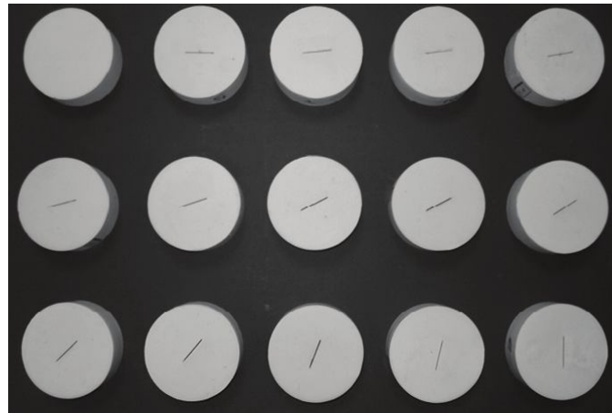
شکل (۳): نمونه های دیسکی حاوی ترک مرکزی با شیب متغیر
