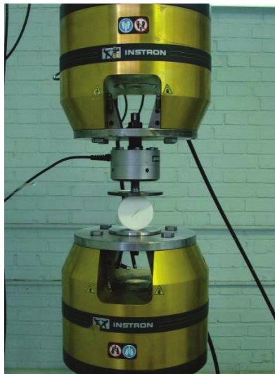
شکل (۴): بارگذاری فشاری نمونه های دیسکی با دستگاه INSTRON و با سلول بار به ظرفیت ۲۵ کیلونیوتن
