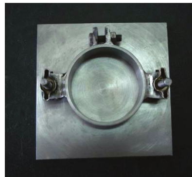
شکل (۲): قالب ساخت نمونه حاوی ترک شیب دار و نحوه ایجاد ترک در آن
