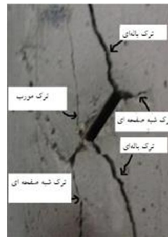
شکل ۱۰: الگوی ترک‌های ایجاد شده در نمونه شبه سنگی حاوی
