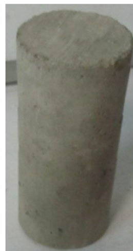
شکل ۷: نمونه شبه سنگی بدون ترک آماده شده برای تست
