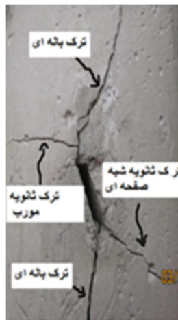
شکل ۱: الگوی ترک‌های ایجاد شده در نمونه شبه سنگی حاوی ترک شیب‌دار مرکزی تحت فشار تک محوری [۱]
