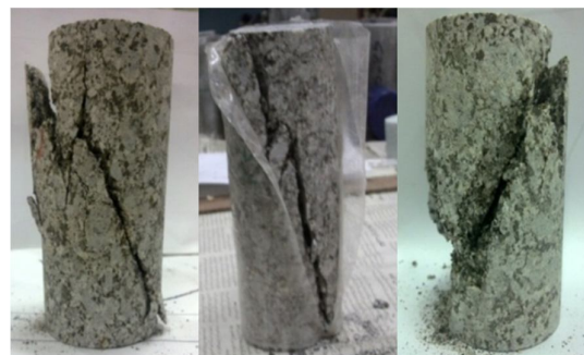
شکل 10: الگوی شکست نمونه‌ها تحت آزمایش تک‌محوره
