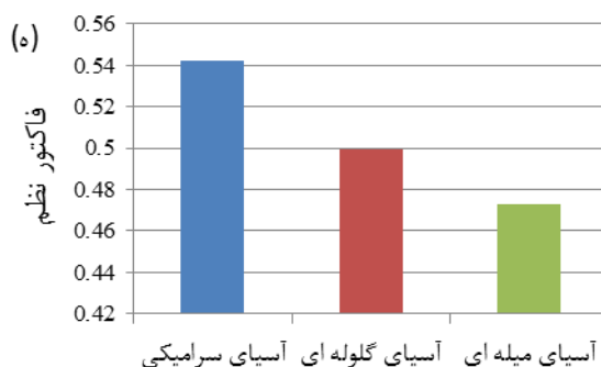
شکل ۳: تغییرات مقادیر میانگین فاکتورهای (الف) کشیدگی، (ب) گردی، (ج) تحدب، (د) گرد شدگی و (ه) فاکتور نظم در آسیاهای میله‌ای، گلوله‌ای و سرامیکی
