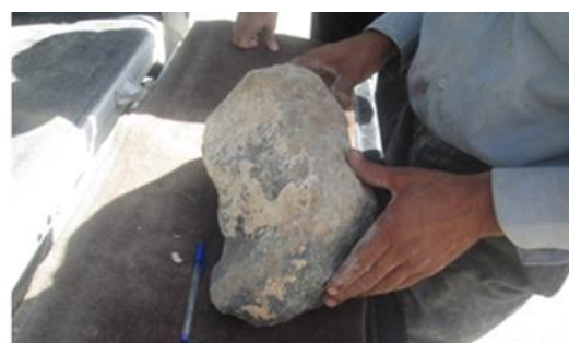
شکل ۲: نمونه سنگ گابرو قبل از برش
