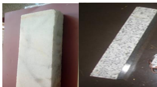
شکل ۳: نمونه گابرو بعد از برش (سمت راست) و نمونه گرانیات بعد از برش (سمت چپ)
