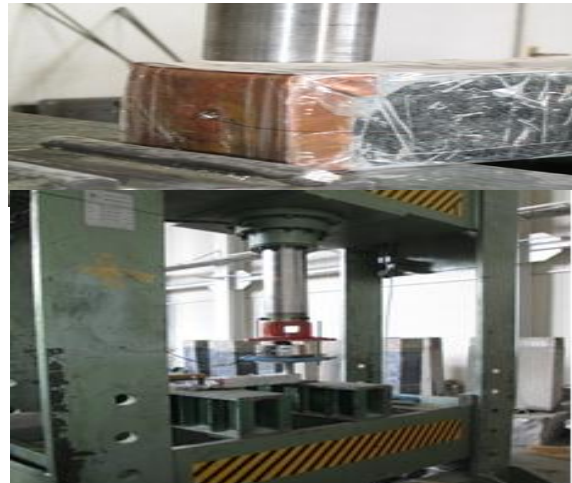
شکل ۶: نمونه گابرو تحت فشار
