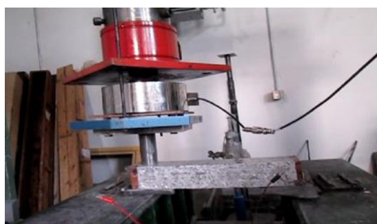
شکل ۵: نمایش کلی از نحوه اتصالات سنگ گابرو جهت اعمال فشار تک‌محوری
