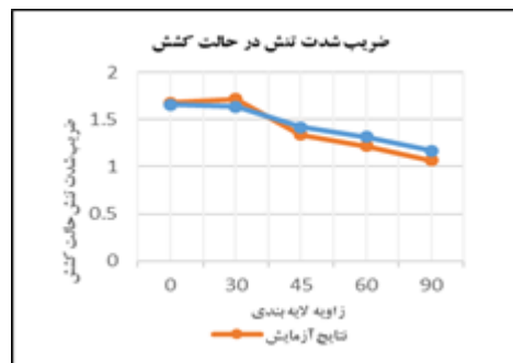
شکل ۵: نتایج آزمایشگاهی و مدل سازی عددی ضریب شدت تنش مود کشش خالص برای E/E'=1.8 و طول ترک ۲۴ میلی‌متر.
