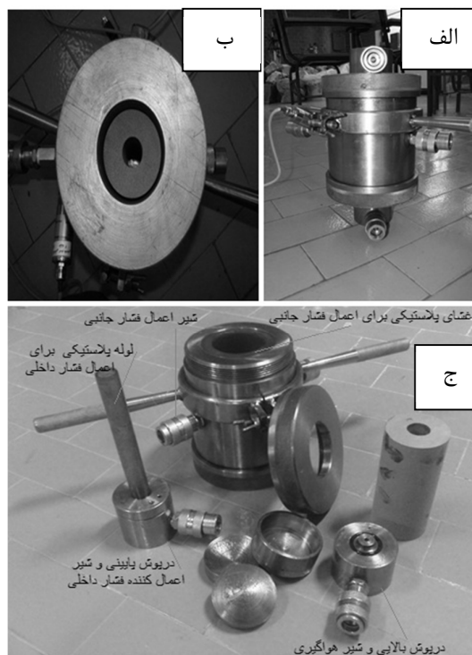
شکل 4: (الف) نمایی کلی از سلول هوک تغییر یافته، (ب) سلول هوک تغییر یافته با نمونه داخل آن در دید از بالا و (ج) اجزای داخلی سلول هوک
