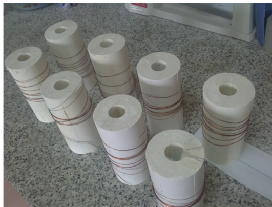
شکل 3: نمایی از نمونه‌های استوانه‌ای تو خالی جدار ضخیم تهیه شده برای آزمایش
